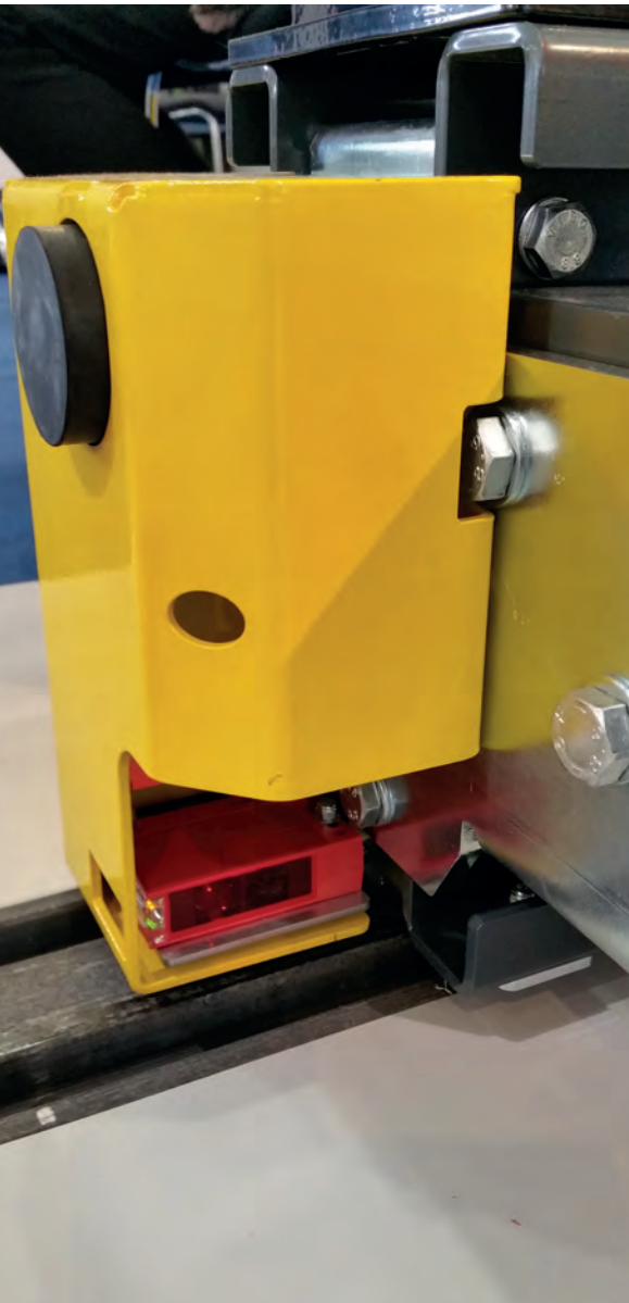
Optimale aanrijdbeveiliging door fotoceltechnologie.
