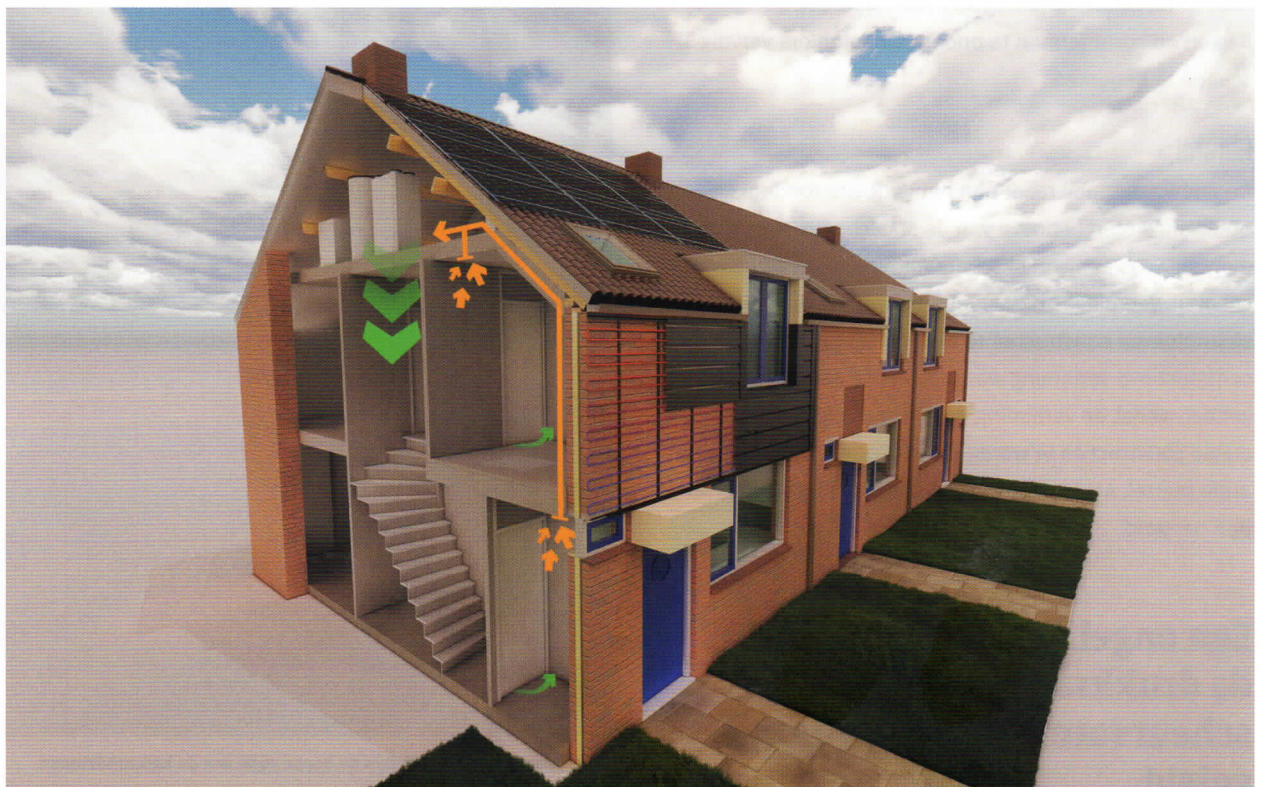
3D-visualisatie van de werking van de warmtewingever. (Bron: TNO)
