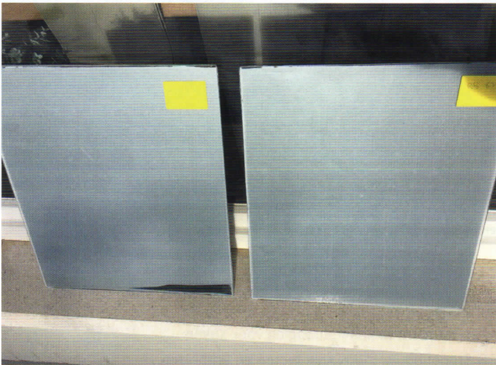
De pv-panelen bestaan uit dunne pv-film op 3 mm glasplaat.
