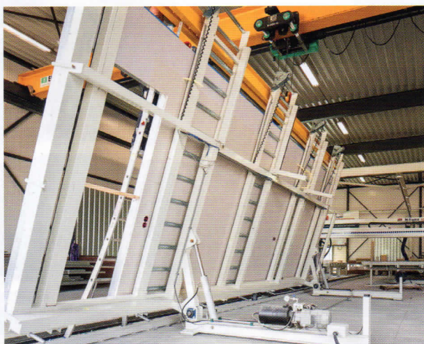
Het wandstelsel wordt in de fabriek bekleed met isolatie en folie.
